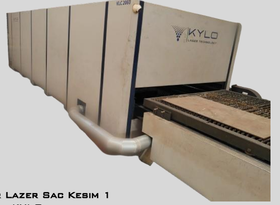
FIBER LAZER SAC KESİM 1 MARKA: KYLO MODEL: KLC 6020 - 6 KW ÇALIŞMA ALANI: 2000x6000MM MAX KESİM KALINLIĞI: 30MM MAX. YÜKLEME KAPASİTESİ: 400KG KESİMDE KULLANILAN GAZLAR: OKSİJEN, AZOT, BASINÇLI HAVA
