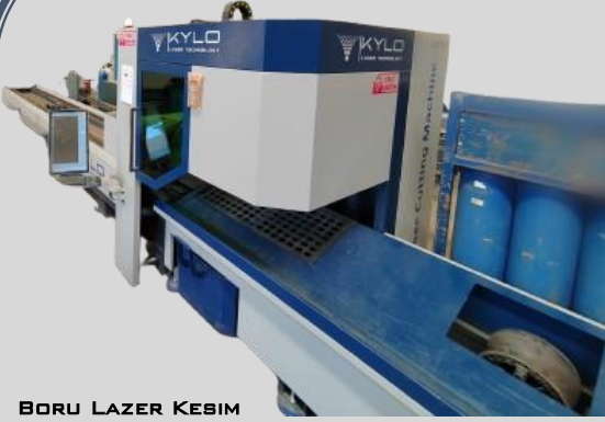
BORU LAZER KESİM MARKA: KYLO MODEL: KLP6020 - 3 KW ÇALIŞMA ARALIĞI: 20x20-220x220x12 MM PROFİL Ø20 - Ø220 BORU MAX. KESİM UZUNLUĞU: 5895 MM MAX. YÜKLEME KAPASİTESİ: 600 KG KESİMDE KULLANILAN GAZLAR: OKSİJEN, AZOT, BASINÇLI HAVA
