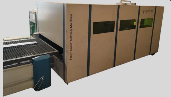
FIBER LAZER SAC KESİM 2 MARKA: KYLO MODEL: KLC 1530 - 2 KW ÇALIŞMA ALANI: 1500x3000 MAX KESİM KALINLIĞI: 12MM MAX. YÜKLEME KAPASİTESİ: 400KG KESİMDE KULLANILAN GAZLAR: OKSİJEN, AZOT, BASINÇLI HAVA
