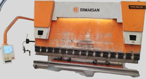
SAC BÜKÜM MARKA: ERMAKSAN MODEL: POWER BEND PRO - 18 KW MAX. ÇALIŞMA ARALIĞI: 3000x220 MAX. BÜKÜM KALINLIĞI: 10 MM
